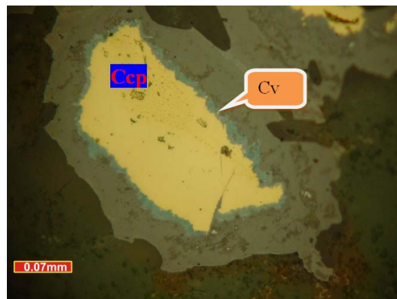
شکل ۶-۲- تصویر میکروسکوپی جانشینی کوولیت به جای کالکوپیریت (نور انعکاسی PPL) کالکوپیریت (Cep) و کوولیت (Cv)
