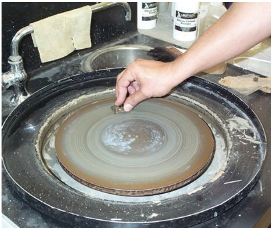
شکل ۲-۴- مرحله سایش نمونه به روش دستی
