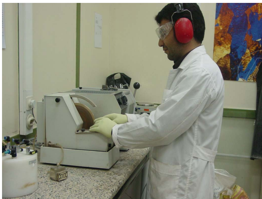
شکل ۲-۲- دستگاه برش سنگ که علاوه بر برش می‌توان با آن نمونه را تا ضخامت ۵۰ میکرون نازک کرد.
